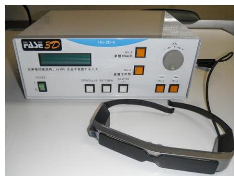
単眼 2D 内視鏡を 3D コンバートし 3D モニター表示します
